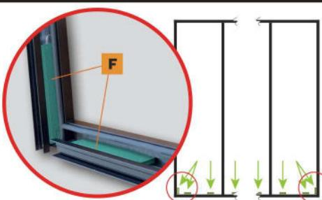
Enfiler le verre dans le Profil Cadre horizontal haut et le laisser reposer sur les cales vertes.
