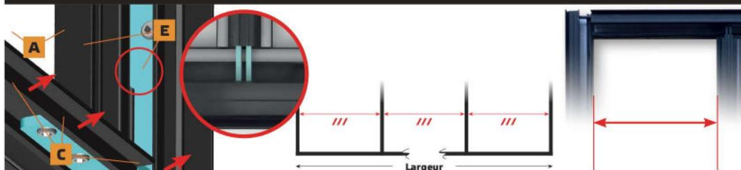
Réglez les Traverses à intervalle égale (bords à bords, voir schéma 1) et serrez les vis des équerres
