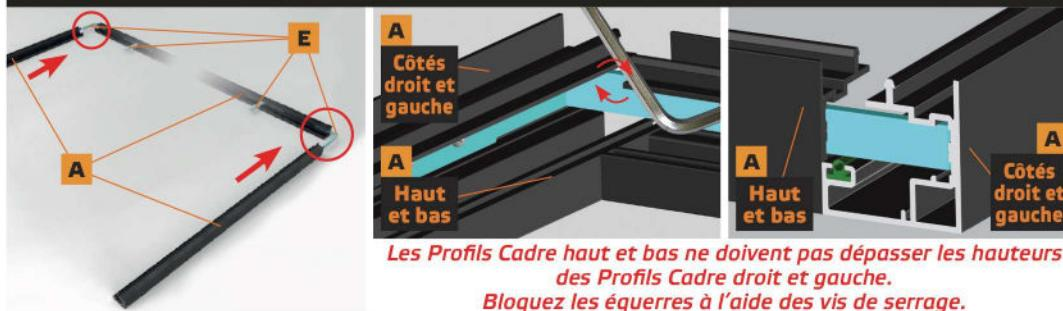
Les Profils Cadre haut et bas ne doivent pas dépasser les hauteurs des Profils Cadre droit et gauche.
