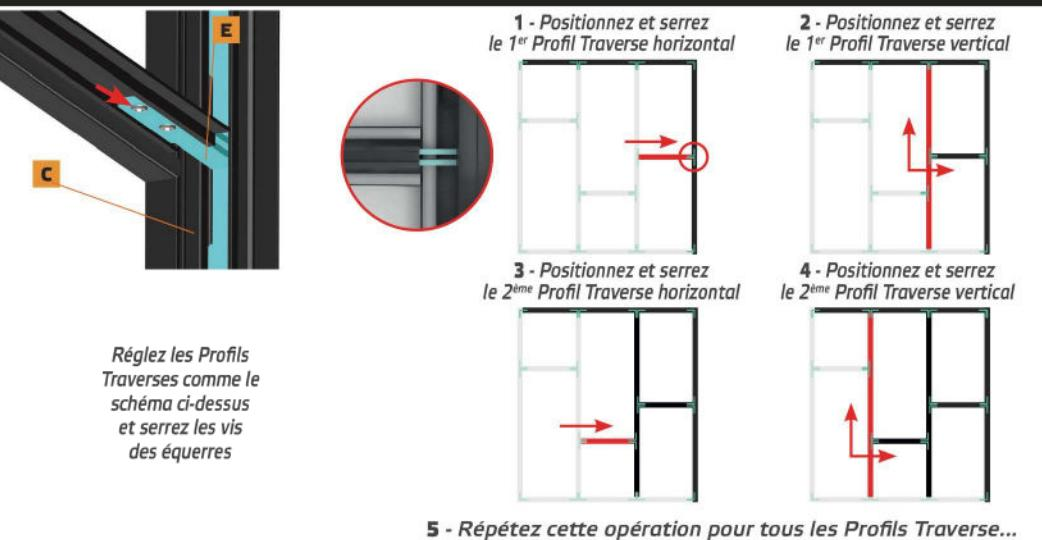
Réglez les Profils Traverses comme le schéma ci-dessus et serrez les vis des équerres
