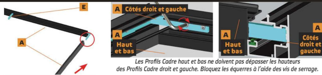
Les Profils Cadre haut et bas ne doivent pas dépasser les hauteurs des Profils Cadre droit et gauche. Bloquez les équerres à l'aide des vis de serrage.
