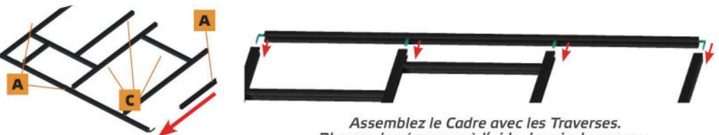
Assemblez le Cadre avec les Traverses. Bloquez les équerres à l'aide des vis de serrage.
