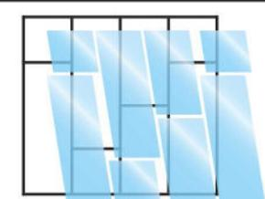
Enfiler le verre dans les Profils horizontaux, laissez reposer sur les cales. Le verre est maintenu !
